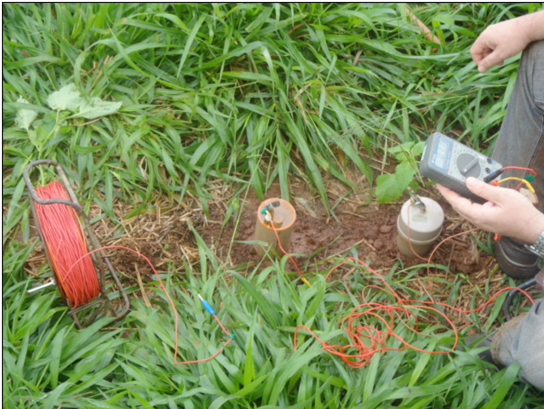
Fotografia 3. Equipamento utilizado no levantamento de Potencial Espontâneo.
